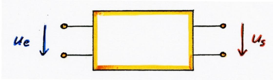
Si on impose une tension d'entrée  $u_e(t)$ , la sortie  $u_s(t)$  sera appelée **la réponse** du quadripôle.
